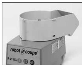
2) Поворачивайте чашу вправо до тех пор пока выступы моторного блока не войдут в предусмотренные для них гнезда.
